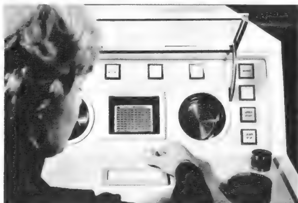
Bild 10. Siemens entwickelte dieses Lesegerät, mit dem Fotos von Fernsprechgebührenzählern völlig automatisch ausgewertet werden können. Rechnungen von 30 000 Fernsprechteilnehmern werden in einer Stunde geschrieben
