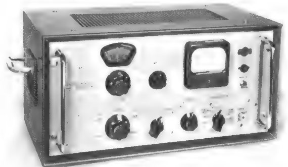
Rechts: Bild 10. Nf-Meßgenerator 817 A von Metrix für Sinus- und Rechtecksignale bis 1 MHz bzw. 100 kHz
