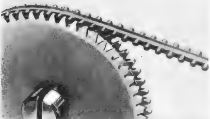
Bild 7. Ein Rundzahnriemen kann auch verschränkt werden und über Kreuz oder durch Rohre laufen (Megatron)
