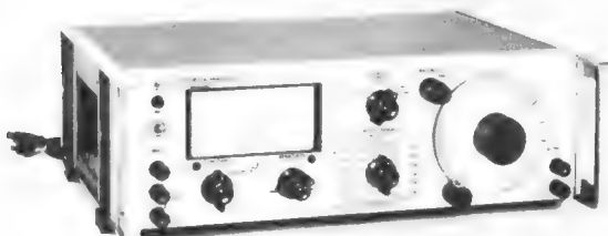
Bild 9. Klirrfaktormesser von Hewlett-Packard zum Ausmessen von Klirrfaktoren bei Frequenzen von 5 Hz bis 600 kHz
